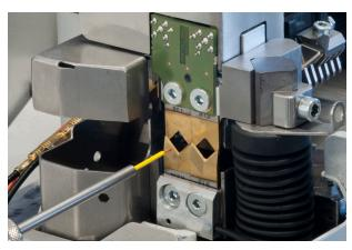
▲ **ACD** Conductor detector sensor
